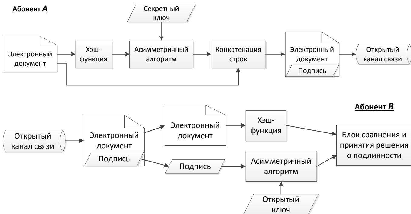
Рисунок 9 – Основные методы построения схем ЭЦП. Схема 3
